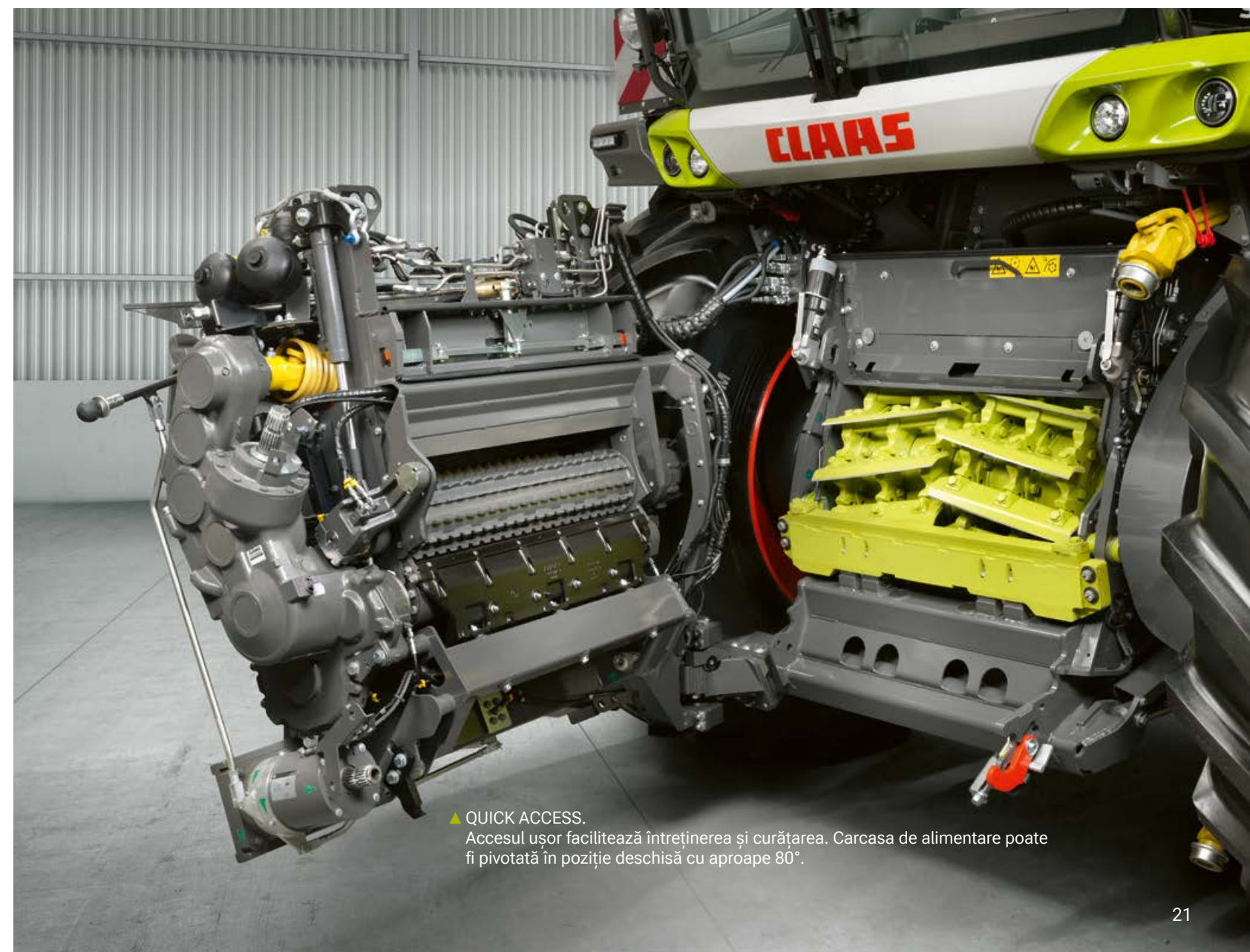
▲ Cadrul rabatabil oferă o compensare laterală controlată, activă (hidraulică) sau pasivă (poziție flotantă), pentru a adapta optim implementele frontale la conturul solului.
