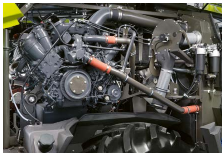
▲ Motorul transversal transmite direct și eficient puterea enormă, de până la 1.110 CP. Puterea este adaptată ideal pentru fluxul mare de material recoltat și echipamentele frontale. Pagina 34
