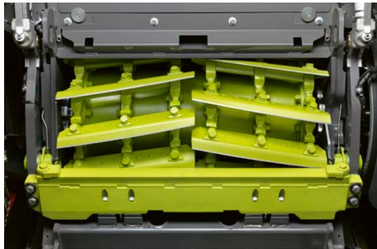
▲ 910 mm laiune V-FLEXi noatrummel lõikab saaki teravalt ja täpselt. Paindlik varustus vastab kõige erinevamatele nõudmistele. Lk 22
