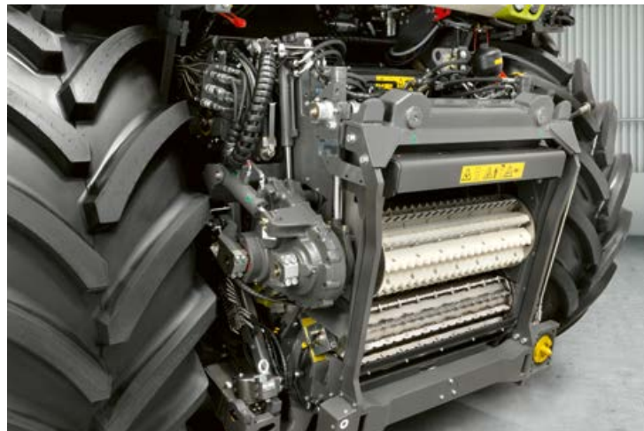
▲ Täishüdrauliline eelpressimine hoolitseb suure läbilaskevõime eest kõigi põllukultuuride ja heksli pikkuste puhul ning säilitab samal ajal ühtlase heksli kvaliteedi. Lk 20
