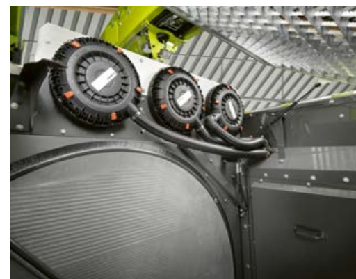
▲ Võimsat mootorit varustavad usaldusväärselt kolm õhufiltrit. Neile pääseb kiireks hoolduseks ligi ilma tööriistadeta.
