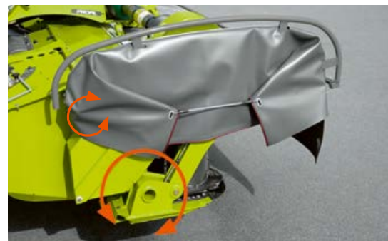
▲ Grâce à son point de pivot surbaissé, la faucheuse DISCO suit parfaitement le profil du terrain.
