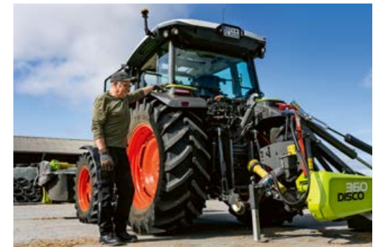
▲ „Die externe Bedienung für Heckkraftheber und Zapfwelle auf beiden Kotflügeln ist echt praktisch. So zügig habe ich noch nie an- und abgekuppelt.“
