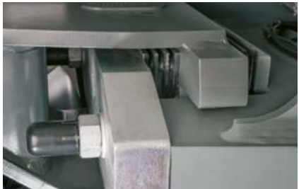
Gummidämpfer im Knickpendelgelenk erhöhen den Arbeitskomfort.
