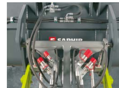
An der Front druckloser Rücklauf und zusätzliche Leckölleitung mit Anschluss am Werkzeugträger (644 / 537)
