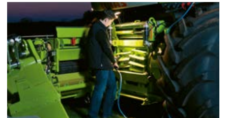
QUICK ACCESS macht die Inspektion der Häckslerorgane in wenigen Minuten möglich.
