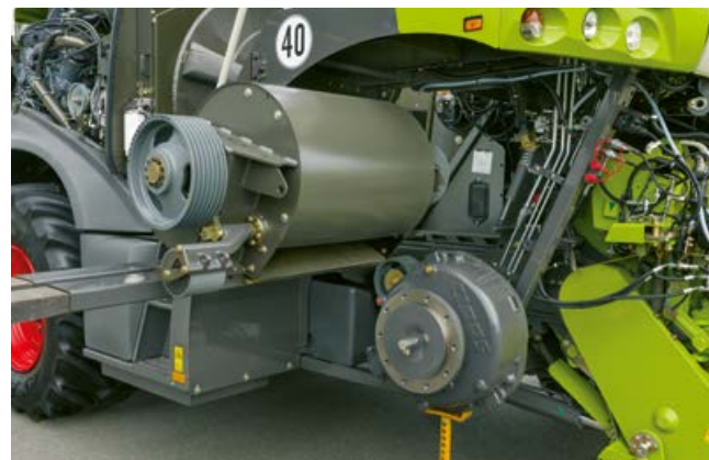
Einfacher Aus- und Einbau des Beschleunigers
