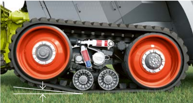
66% Aufstandsfläche: Die Laufrolle wird bei Kurvenfahrten angehoben.
