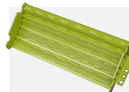
Trommelboden mit Reibelementen für zusätzliche Erntegutaufbereitung
