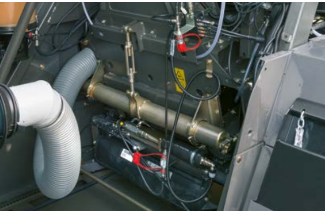
Mechanische Spalteinstellung des Auswurfbeschleunigers
