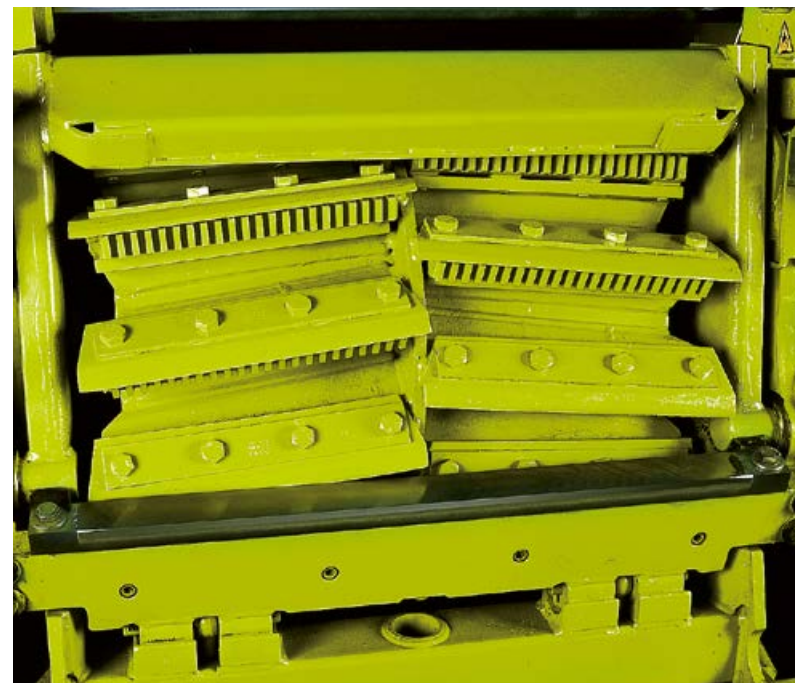
Mikroschlagleisten unter den Messern für zusätzliche Erntegutaufbereitung
