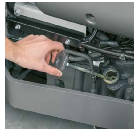
Sprawdzanie poziomu oleju i jego uzupełnianie można wykonywać przy opuszczonej masce z prawej strony ELIOS 2.
