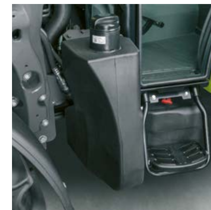
Zbiornik oleju napędowego 95 l i zbiornik mocznika 10 l zapewniają wystarczający zasięg nawet w długie i intensywne dni pracy.
