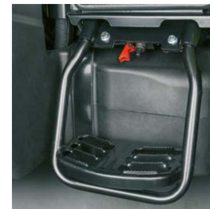
Odłącznik akumulatora jest wygodnie umieszczony przy lewym wejściu (za wyjątkiem ELIOS 2.75)
