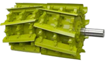
Puoli terämäärä kaksinkertaistaa silpun pituuden, käytettäessä ilman jyvämurskainta.
