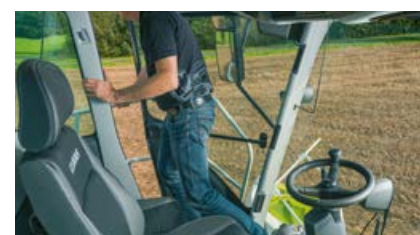
Istuinkytin kytkee etuvarusteen ja päävoimansiirron automaattisesti pois päältä.
