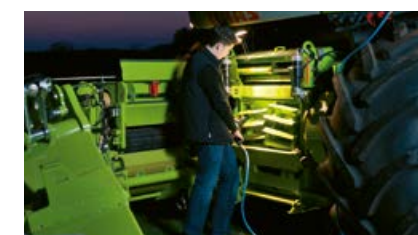
QUICK ACCESS mahdollistaa silppurikoneiston tarkistuksen muutamassa minuutissa.
