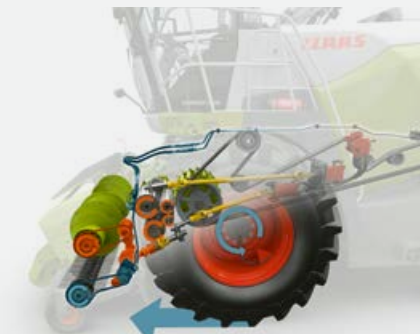
Trasmissione della testata a portata variabile
