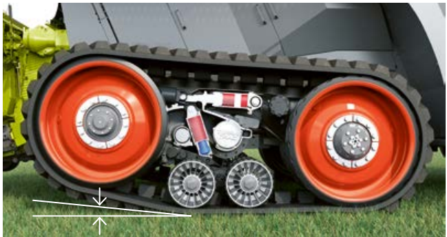
66% di superficie di appoggio: il rullo di scorrimento viene sollevato nei tratti in curva.
