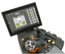
ISOBUS w CEBIS. Obsługa maszyny bezpośrednio na terminalu ciągnika kompatybilnym z ISOBUS.
