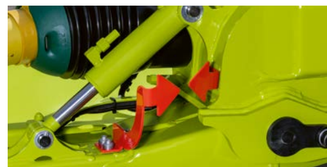
Łatwe ustawianie wysokości ramy środkowej: strzałki muszą wskazywać na siebie nawzajem.
