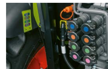
Priključke na zadnji strani je enostavno prepoznati zaradi barvnih oznak in nalepk, ki so nalepljene v bližini.
