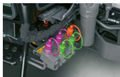
Na sprednjem delu so na voljo največ štirje hidravlični priključki ter en prosti povratek.
