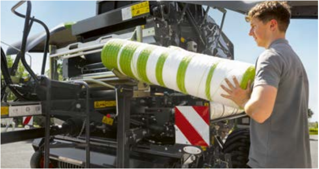
El nuevo atado de malla de la serie VARIANT 500 es un 25 cm más bajo, para poder limpiar sin problemas el carrete de malla debajo del freno de malla.
