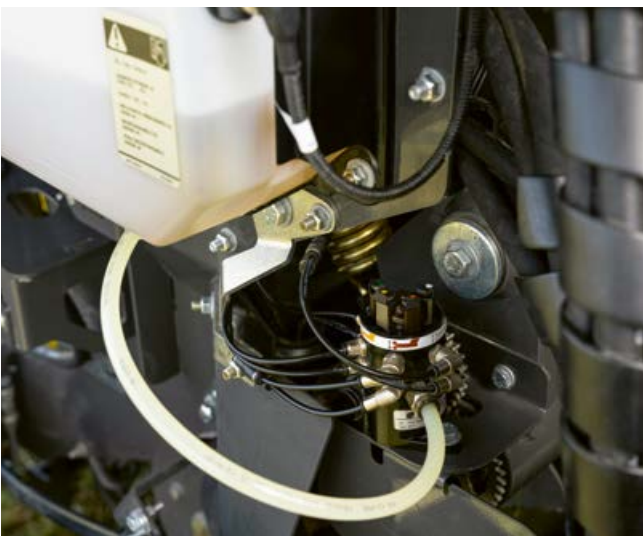
Lubrifiere permanentă a lanțurilor.
