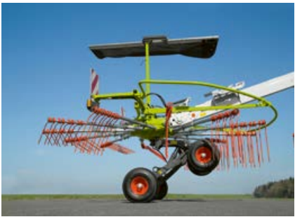
Gran altura de elevación para sobrepasar hileras en cabeceras: Hasta 50 cm en LINER 700 TWIN.
