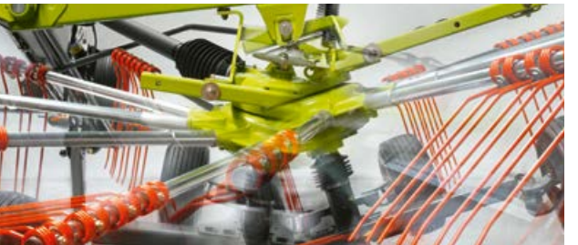
Articulation cardanique pour que les rotors s'adaptent aux reliefs du terrain, indépendamment du tracteur
