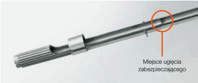
Optymalna ochrona: w razie kolizji ramiona zginają się w kontrolowany sposób w wyznaczonym miejscu.
