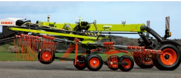
De rotor gedraagt zich bij het heffen en dalen op dezelfde manier als een vliegtuig tijdens het starten en landen: het 'JET-effect'.
