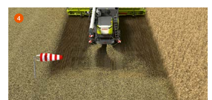
3 Capteurs à l'arrière de la machine pour évaluer la force du vent latéral 4 Correction de la direction d'épandage des résidus
