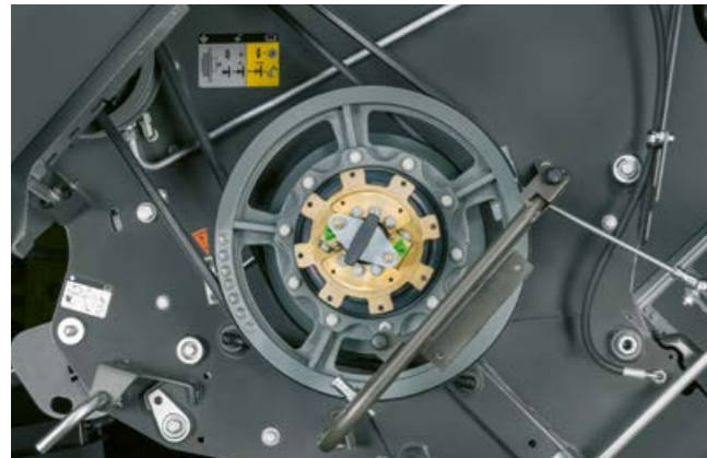
Régime broyeur ajustable facilement, rapidement et sans outils selon les conditions de récolte
