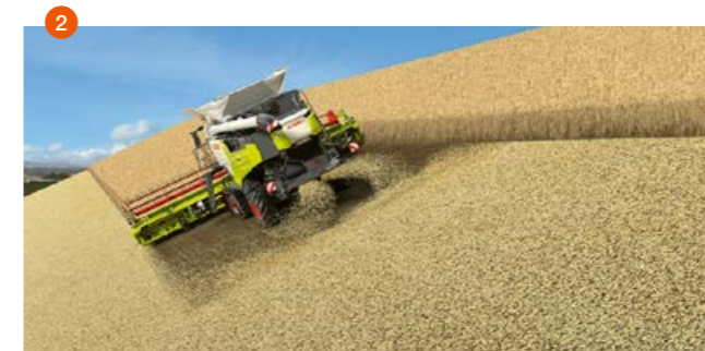
1 Ajustement automatique de la direction d'épandage en dévers 2 Épandage uniforme des résidus sur toute la largeur de travail
