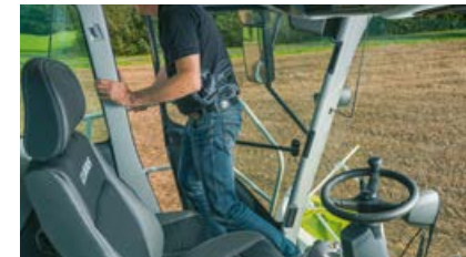
Der Sitzschalter schaltet Vorsatz und Hauptantrieb automatisch aus.
