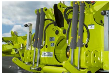
De standaard hef- en ontlastingscilinders van het ACTIVE FLOAT ontlastingssysteem garanderen een werkresultaat dat de graszode ontziet.
