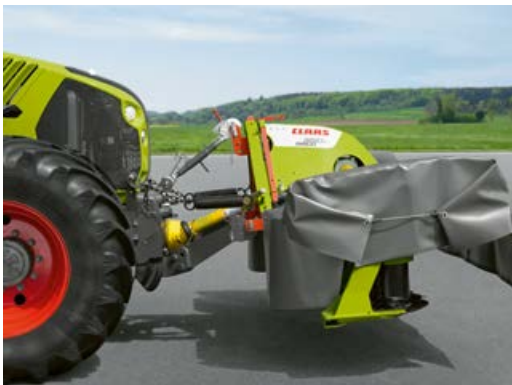
Dependiendo del equipamiento, un muelle ajustable o ACTIVE FLOAT descargan la segadora.
