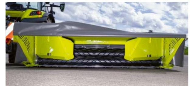
Les conditionneurs à rouleaux peuvent être complétés en option de deux tôles à andain additionnelles télescopiques.
