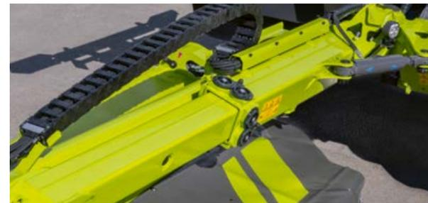
Grâce à leur structure renforcée, les bras télescopiques réglables en continu contribuent à la solidité et à la longévité extrêmes de la faucheuse. La correction automatique des réglages est assurée par des ressorts.
