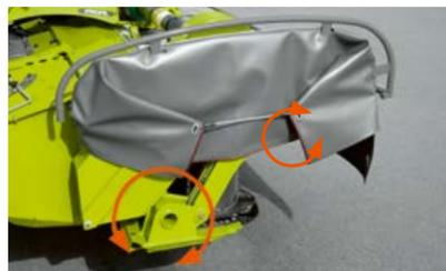
Grâce au point de pivot surbaissé, la faucheuse suit le profil du sol avec précision.
