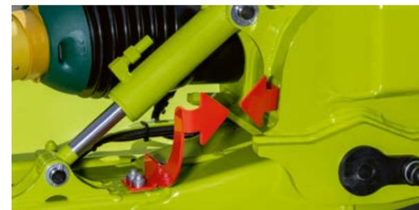
Réglage aisé de la hauteur du châssis central par positionnement des pointes des flèches à la même hauteur
