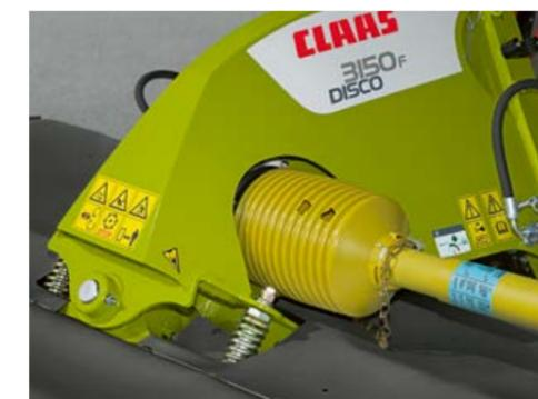
Le système de balancier intelligent sur l'axe transversal, combiné au point de pivot surbaissé, garantit un fauchage propre et une excellente protection de la couche végétale.
