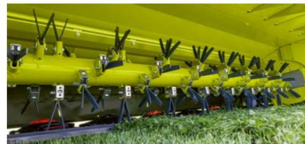
Insensible à l'usure, le capot de conditionneur en acier Hardox est conçu pour durer longtemps, même dans les conditions les plus extrêmes.
