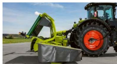
Pour mettre les tapis au repos, il suffit de les basculer vers l'avant, au-dessus des unités de fauche, ce qui permet de rapprocher le centre de gravité de la faucheuse très près du tracteur.
