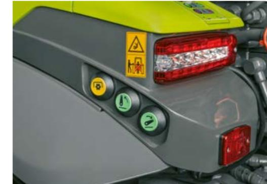
▲ Grazie alla disposizione chiara e alla codifica a colori delle interfacce idrauliche, si possono agganciare e sganciare rapidamente gli attrezzi. Il sollevatore posteriore e la presa di forza possono essere gestiti comodamente tramite i comandi esterni sui parafanghi.
