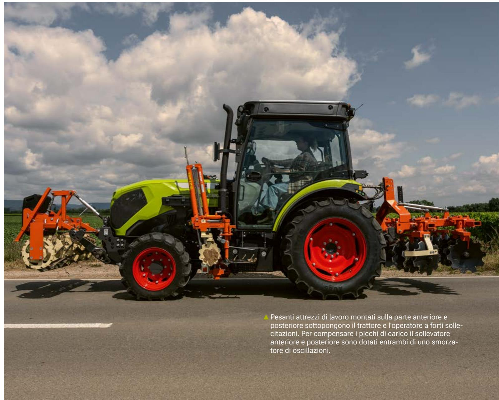
▲ Pesanti attrezzi di lavoro montati sulla parte anteriore e posteriore sottopongono il trattore e l'operatore a forti sollecitazioni. Per compensare i picchi di carico il sollevatore anteriore e posteriore sono dotati entrambi di uno smorzatore di oscillazioni.
