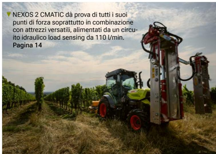
▼ NEXOS 2 CMATIC dà prova di tutti i suoi punti di forza soprattutto in combinazione con attrezzi versatili, alimentati da un circuito idraulico load sensing da 110 l/min.
