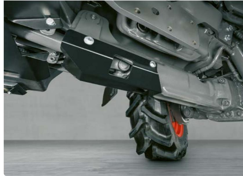
◀ L'ampia escursione della sospensione di 80 mm assorbe gli urti in modo eccellente. I movimenti di beccheggio in accelerazione o in frenata sono compensati in modo affidabile.
