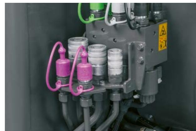
◀ Power Beyond consente di risparmiare potenza del motore e di ridurre il consumo di carburante. Per gli attrezzi con unità di comando proprie o motori idraulici, potete utilizzare gli attacchi Power Beyond nella zona dell'assale centrale. In questo modo l'attrezzo gestisce autonomamente il proprio fabbisogno di olio, senza ricircolo permanente.
