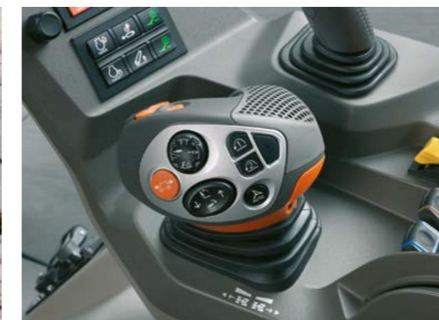
▲ Potete scegliere liberamente, senza impostazioni preliminari, se attivare la funzione di inversione tramite REVERSESHIFT, CMOTION o ELECTROPILOT.
