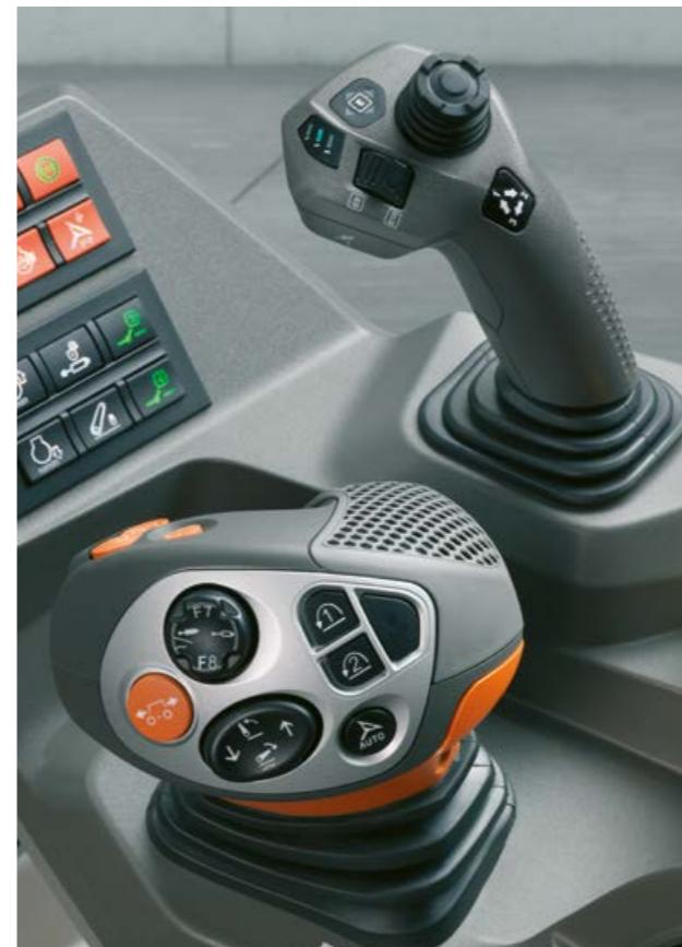
◀ Con ELECTROPILOT avete sotto controllo tutti e quattro i distributori elettronici, compreso il doppio duplicatore. In alternativa potete comandare i distributori 1 e 2 anche tramite la leva multifunzione CMOTION.
