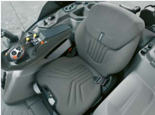
Buenas vistas. Trabajo seguro. Hasta doce faros LED iluminan homogéneamente su entorno. El asiento premium con amortiguación neumática de baja frecuencia, con un ancho asiento y respaldo, así como el reposabrazos integrado, ofrecen en todos los modelos NEXOS M, L y XL un perceptible incremento del confort.
