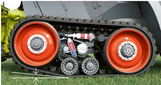
Powierzchnia przylegania 66%: rolka jezdna podnosi się podczas jazdy na zakrętach.
