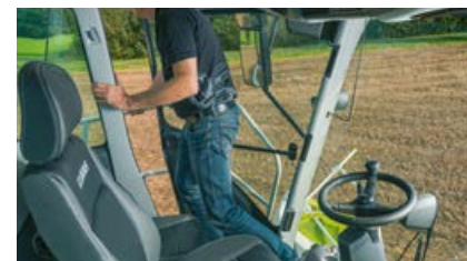
Wyłącznik w fotelu automatycznie wyłącza przyrząd roboczy i napęd główny.
