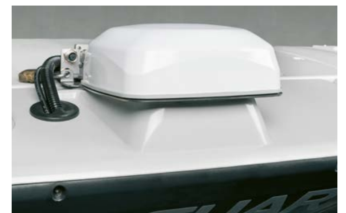
Antena SAT 900 i odbiornik w jednym – z zabezpieczeniem przed kradzieżą
