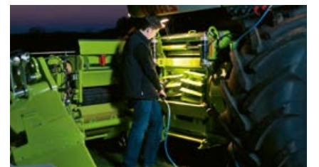
QUICK ACCESS umożliwia kontrolę zespołu tnącego w parę minut.
