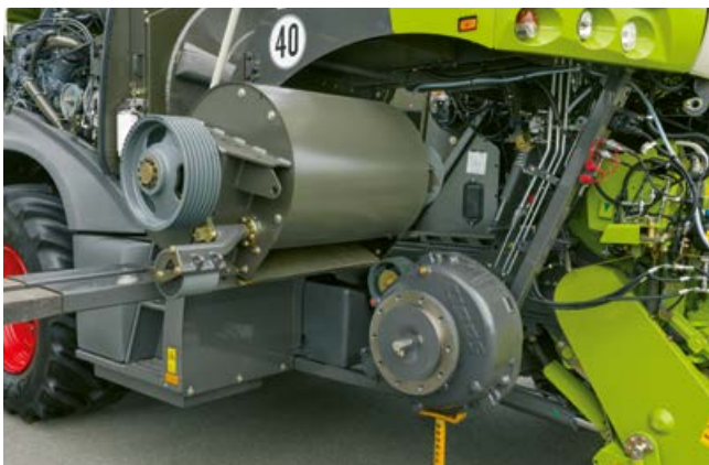
Eenvoudig in- en uitbouwen van de uitwerpversneller
