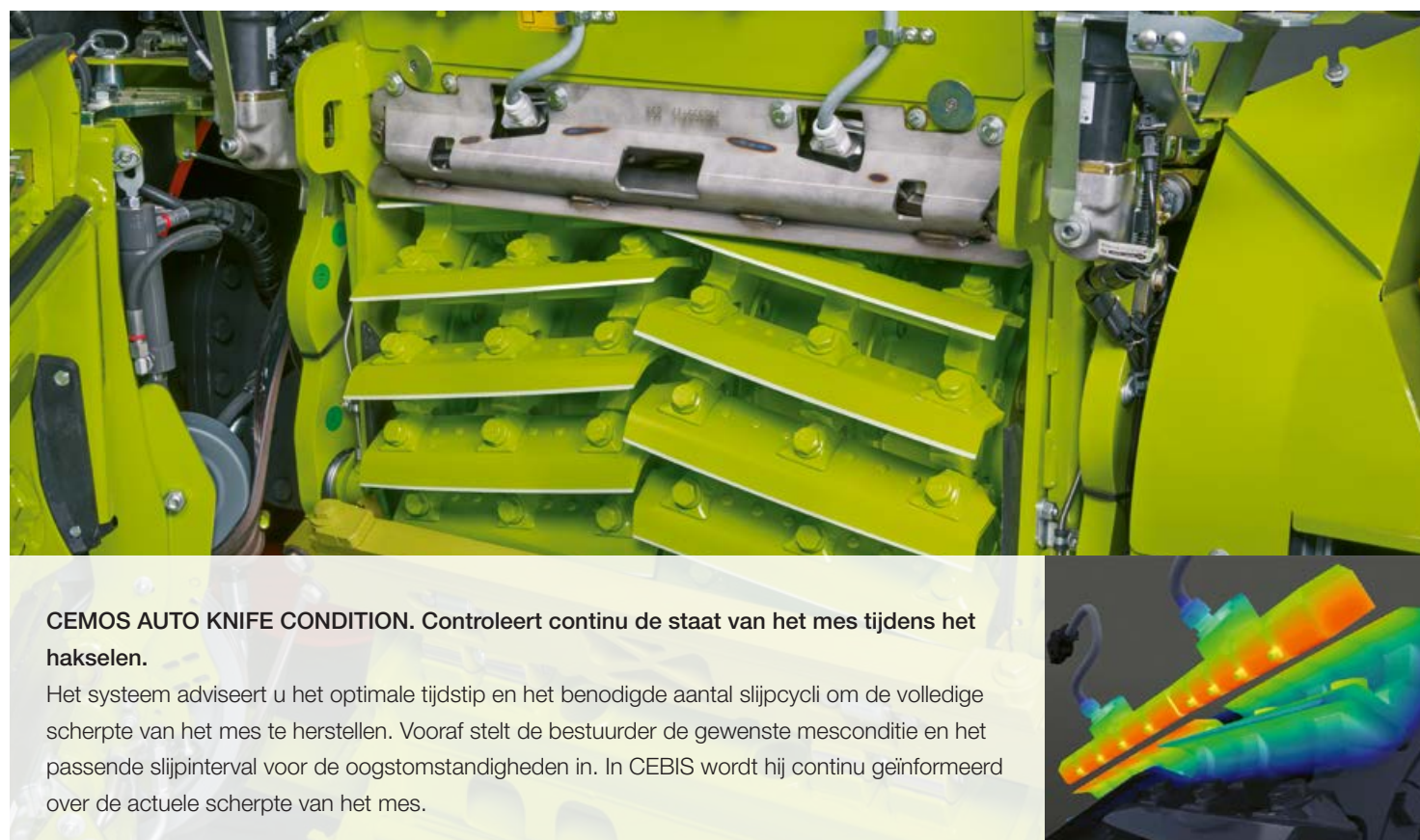
Messtatusdetectie via magnetische veldinductie
