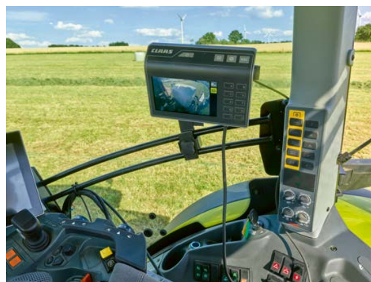
▲ Trois modes de commande différents au choix : fonction tactile, pression sur une touche ou molette.
