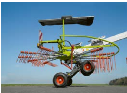
Suuri nostokorkeus karhojen ylittämiseksi päisteissä: LINER 700 TWIN -mallissa jopa 50 cm.
