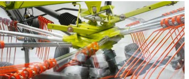
Roottorin kardaaniiripustus: roottorit mukautuvat pellon pintaan – traktorista riippumatta.
