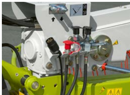
Vakiovarusteena etu- ja takaroottorin hydraulinen jakso-ohjaus nostettaessa ja laskettaessa.
