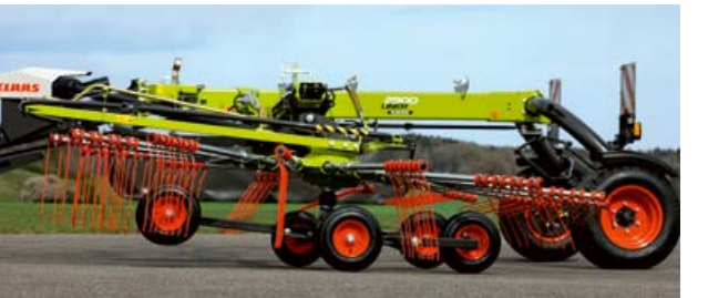
Tasainen nousu ja lasku: roottori käyttäytyy nostettaessa ja laskettaessa kuten lentokone nousun ja laskun aikana.
