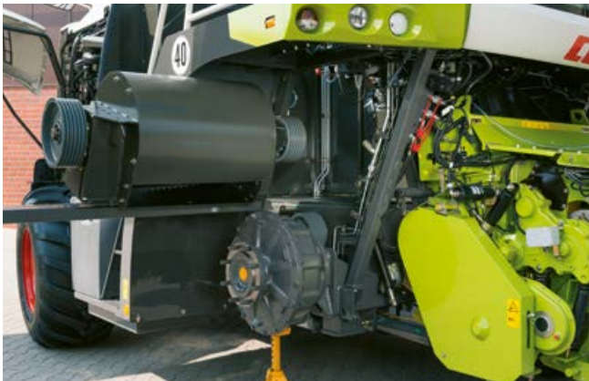
Einfacher Aus- und Einbau des Beschleunigers
