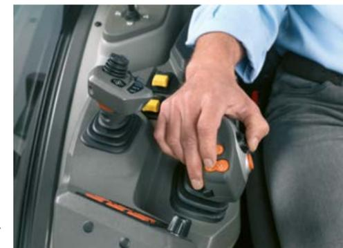
► Mit einer Hand alles im Griff dank CMOTION. Durch die Bedienung der Funktionen mit Daumen, Zeige- und Mittelfinger ermüdet die Hand beim Arbeiten nicht so schnell, zumal der Arm auf der gepolsterten Lehne ruht.
