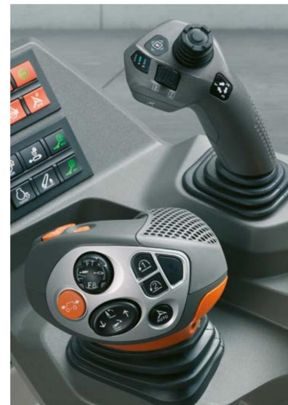
◀ Mit dem ELECTROPILOT haben Sie alle vier elektronischen Steuergeräte inklusive Doppelduplikator im Griff. Alternativ können Sie die Steuergeräte 1 und 2 auch über den CMOTION Multifunktionsgriff steuern.
