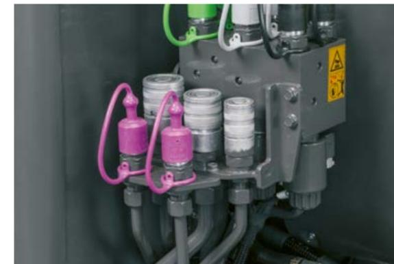
◀ Power Beyond spart Motorleistung und reduziert den Kraftstoffverbrauch. Für Anbaugeräte mit eigenen Steuereinheiten oder hydraulischen Motoren nutzen Sie die Power-Beyond-Anschlüsse im Zwischenachsenbereich. Damit steuert das Anbaugerät seinen Ölbedarf selbstständig, ohne permanenten Ölumlaufl.
