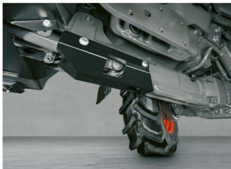
Der großzügige 80-mm-Federweg fängt Stöße souverän ab. Nickbewegungen beim Beschleunigen oder Bremsen werden zuverlässig ausgeglichen.
