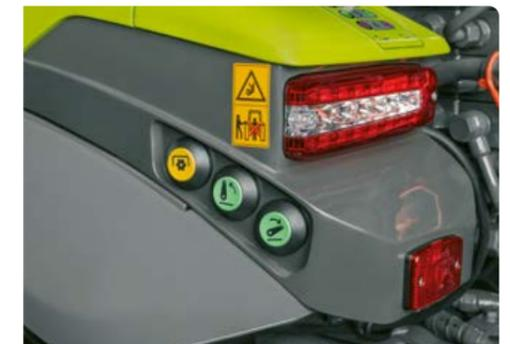
▲ Dank der klaren Anordnung und Farbkodierung der hydraulischen Schnittstellen koppeln Sie Anbaugeräte schnell an und ab. Heckkraftheber und Zapfwelle steuern Sie bequem über die externen Bedienelemente an den Kotflügeln.
