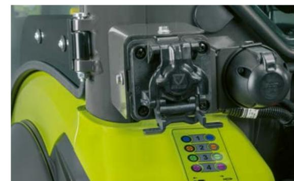
◀ Der NEXOS 2 CMATIC ist ISOBUS-vorbereitet und unterstützt die Anzeige und Steuerung angebundener Geräte.
