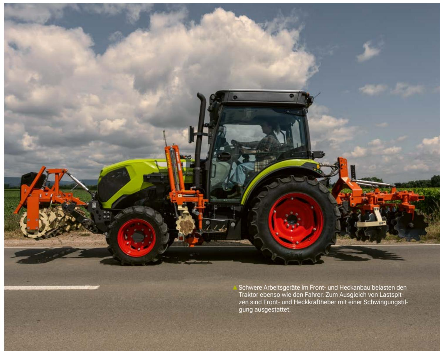
Schwere Arbeitsgeräte im Front- und Heckanbau belasten den Traktor ebenso wie den Fahrer. Zum Ausgleich von Lastspitzen sind Front- und Heckkraftheber mit einer Schwingungstilgung ausgestattet.
