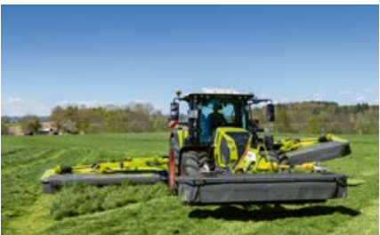
Die kompakte Aufhängung schafft große Bodenfürfreiheit am Vorgewende.
