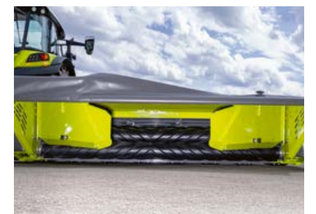
Zusatzschwabbleche für ein engeres Schwad.
