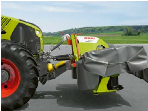
Je nach Ausstattung entlasten eine einstellbare Feder oder ACTIVE FLOAT das Mäherwerk.
