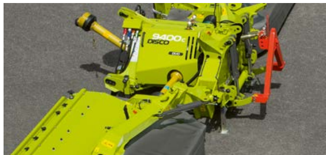
Schutz durch hydraulische Non-Stop-Anfahrsicherung im Fall einer Kollision: Mäheinheit schwenkt aus und positioniert sich selbstständig in die Ausgangsposition.
