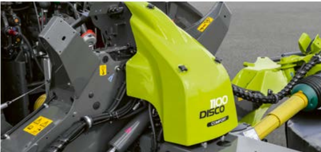
Kompakter und stabiler Anbaubock mit serienmäßig integriertem ACTIVE FLOAT Entlastungssystem.
