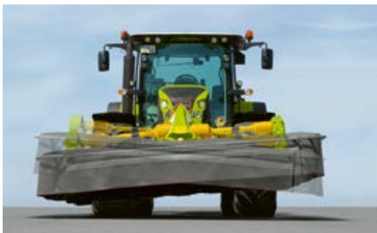
Die frei pendelnde Aufhängung gleicht Unebenheiten quer zur Fahrtrichtung aus.
