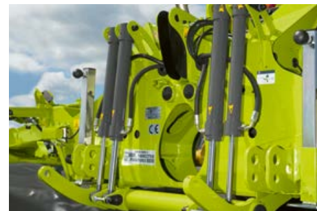
Die serienmäßigen Aushub- und Entlastungszyylinder des ACTIVE FLOAT Entlastungssystems garantieren ein grasnarbenschonendes Ergebnis.
