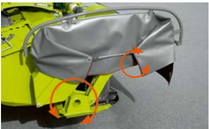
Durch den tief sitzenden Drehpunkt folgt das DISCO präzise dem Boden.
