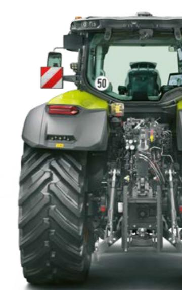
► L'AXION 9 CMATIC è ideale per l'uso di attrezzature complesse come seminatrice o cisterne per liquame. Due potenti pompe idrauliche erogano fino a 370 l/min.
