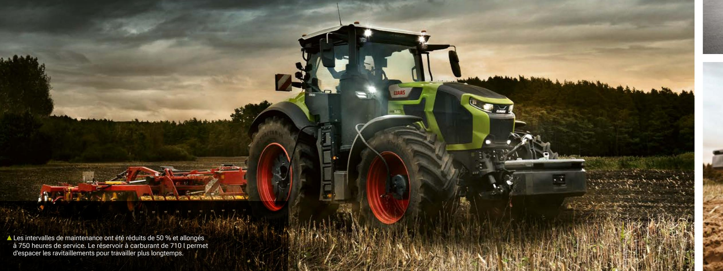
▲ Les intervalles de maintenance ont été réduits de 50 % et allongés à 750 heures de service. Le réservoir à carburant de 710 l permet d'espacer les ravitaillements pour travailler plus longtemps.
