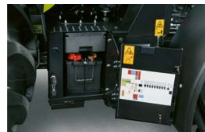
Parempoolses trepis paiknevad aku, tööriistakast ja suruõhuühendus, milledele pääsete lihtsalt ligi.
