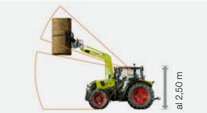
Madala katusega kabiin, millel on klaasist katuse-luuk: läbisõidukõrgus al 2,50 m.
