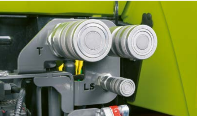
Enda juhtseadistega haakeriistale on traktori taga koormustundliku ahela jaoks Power Beyondi ühendused. Sel juhul juhib haakeriist oma õlitarvet ise, kaotades vajaduse pideva õliringluse järele.
