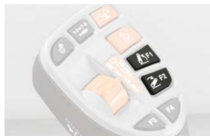
Tagarippsüsteemi saate juhtida nii külgkonsooli kui ka mitmfunktsioonilise hoova kaudu.
