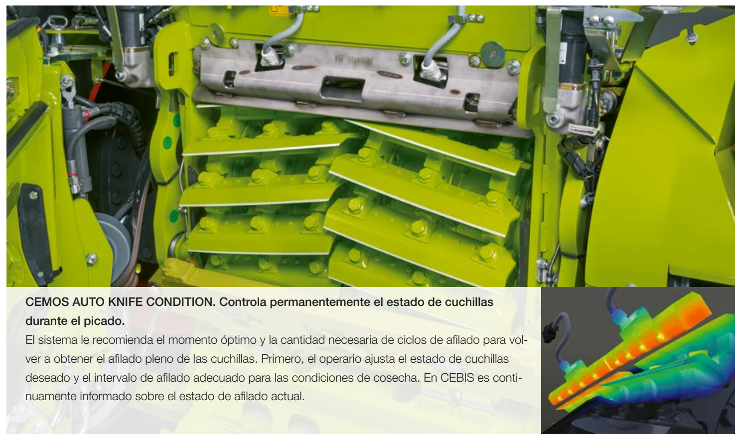
Reconocimiento del estado de cuchillas a través de la inducción del campo magnético
