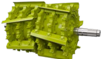
Funcionamiento con un tercio de las cuchillas (solo en V-36) para longitudes de corte muy largas con una colocación simétrica del material de cosecha.
