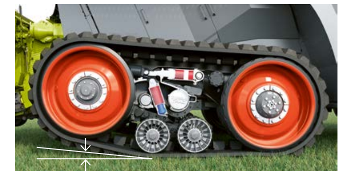
66% Aufstandsfläche: Die Laufrolle wird bei Kurvenfahrten angehoben.
