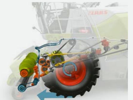
Accionamiento variable del cabezal
