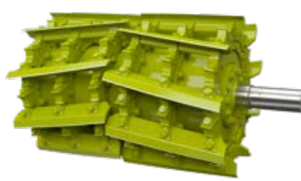
La mitad del número de cuchillas para una longitud de corte doble al trabajar sin corncracker.
