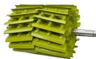
Funcionamiento con la totalidad de las cuchillas para longitudes de corte de cortas a medianas.
