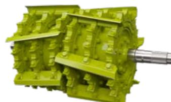
Funcionamiento con un tercio de las cuchillas (solo en V-36) para longitudes de corte muy largas con una colocación simétrica del material de cosecha.
