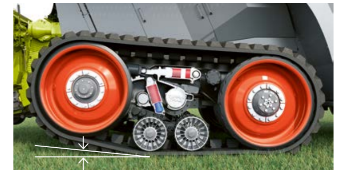
66 % de superficie de apoyo: La roldana se eleva en trayectos con curvas.
