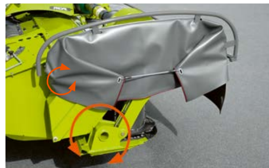
▲ Durch den tief sitzenden Drehpunkt folgt das DISCO präzise dem Boden.
