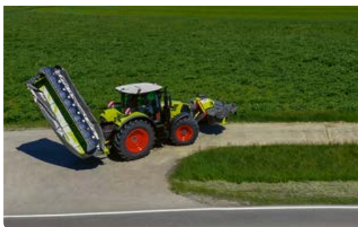
▼ Selbst das größte DISCO macht sich klein: kompakte Transportposition trotz 4,20 m Arbeitsbreite.
