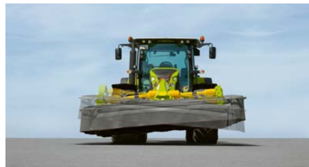
▲ Die frei pendelnde Aufhängung gleicht Unebenheiten quer zur Fahrtrichtung aus.
