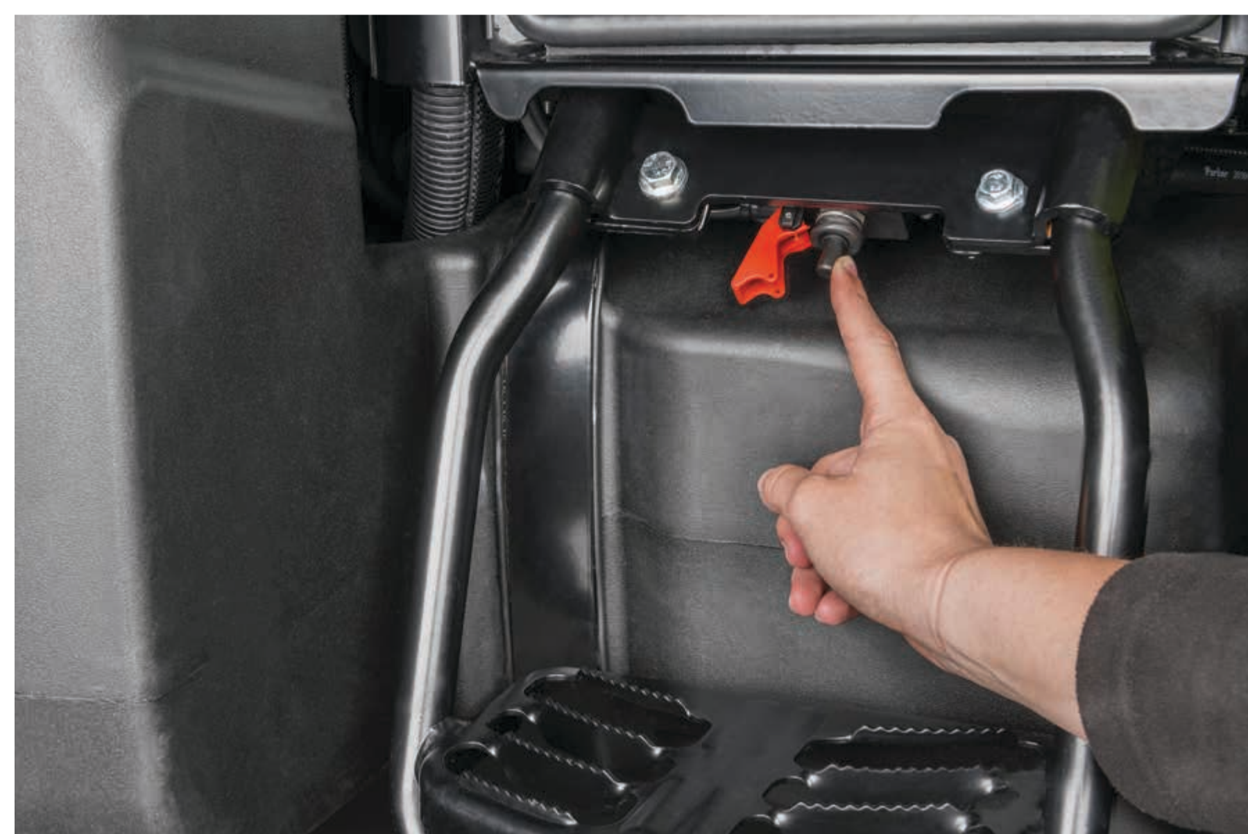
Le coupe batterie électrique est placé au niveau du marche-pieds gauche
