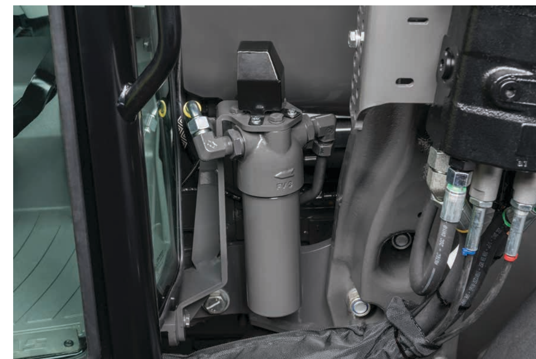
Deuxième filtre à huile hydraulique côté droit du moteur
