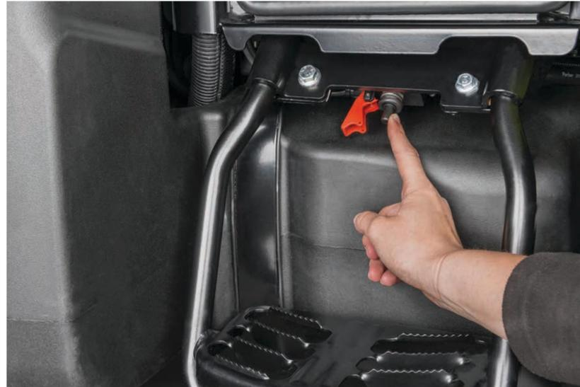
El interruptor separador de la batería eléctrico se encuentra a la altura del escalón izquierdo
