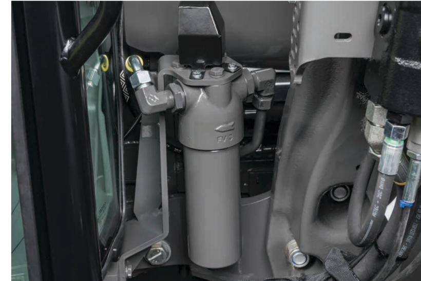
2. filtro de aceite hidráulico en el lado derecho del motor
