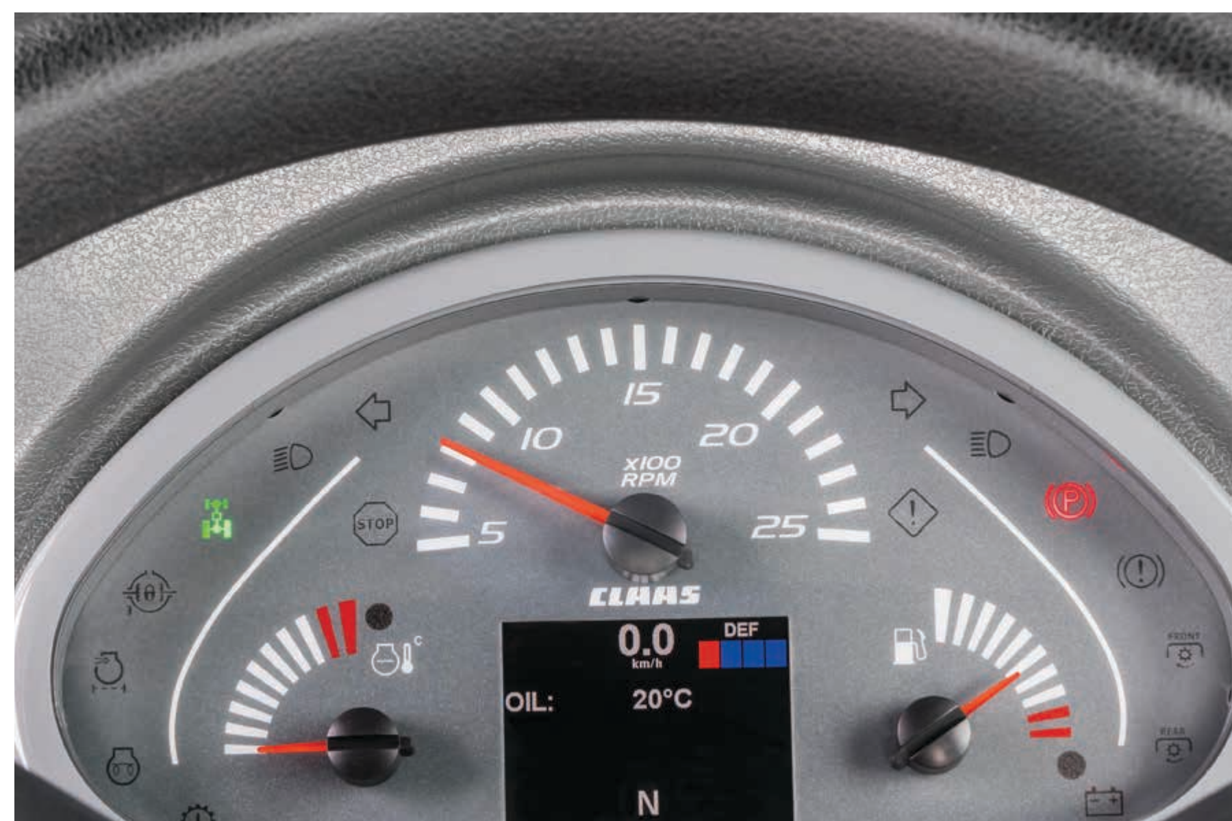
Temperatura oleju w przekładni
