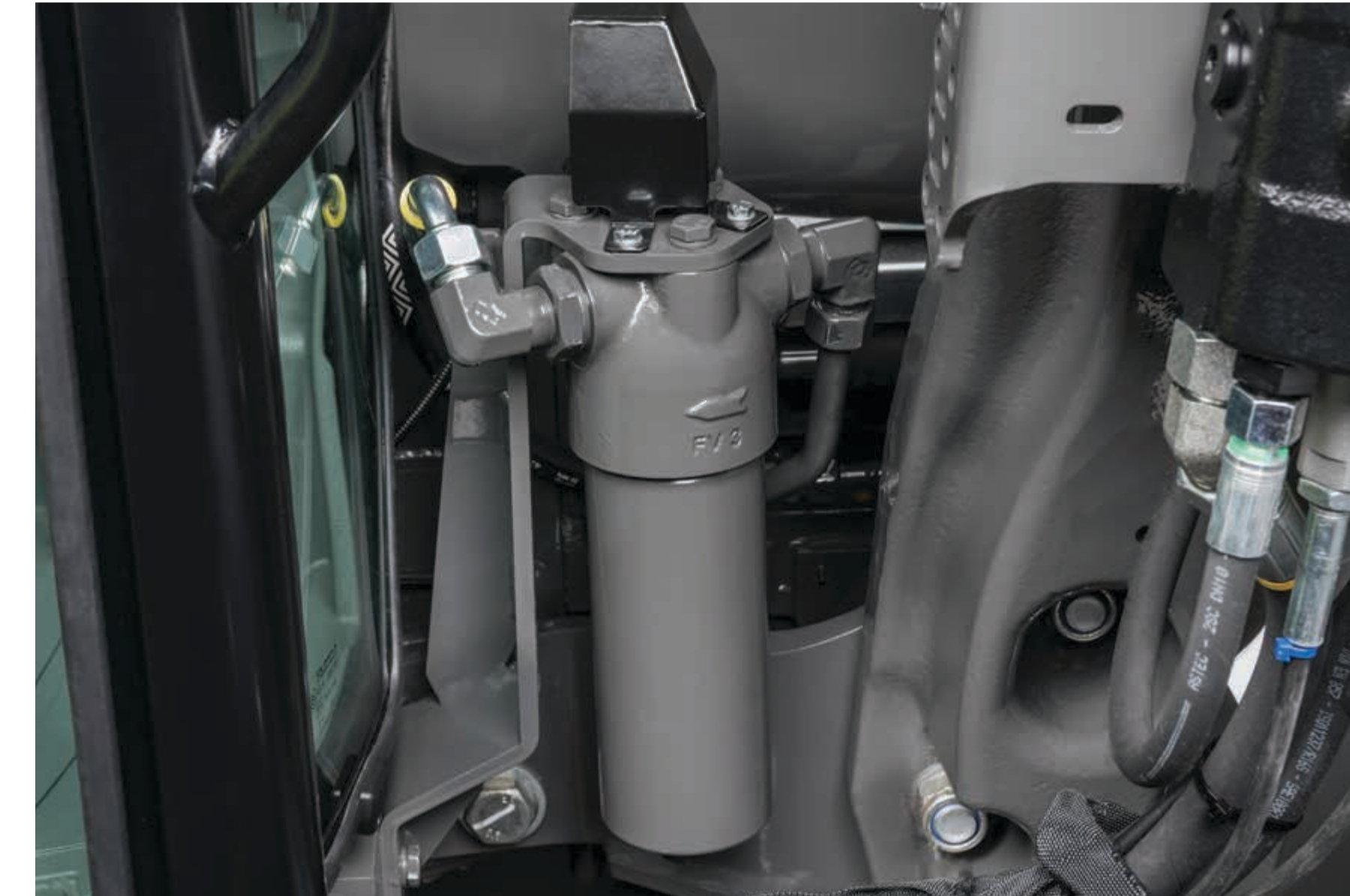
2. filtr oleju hydraulicznego z prawej strony silnika
