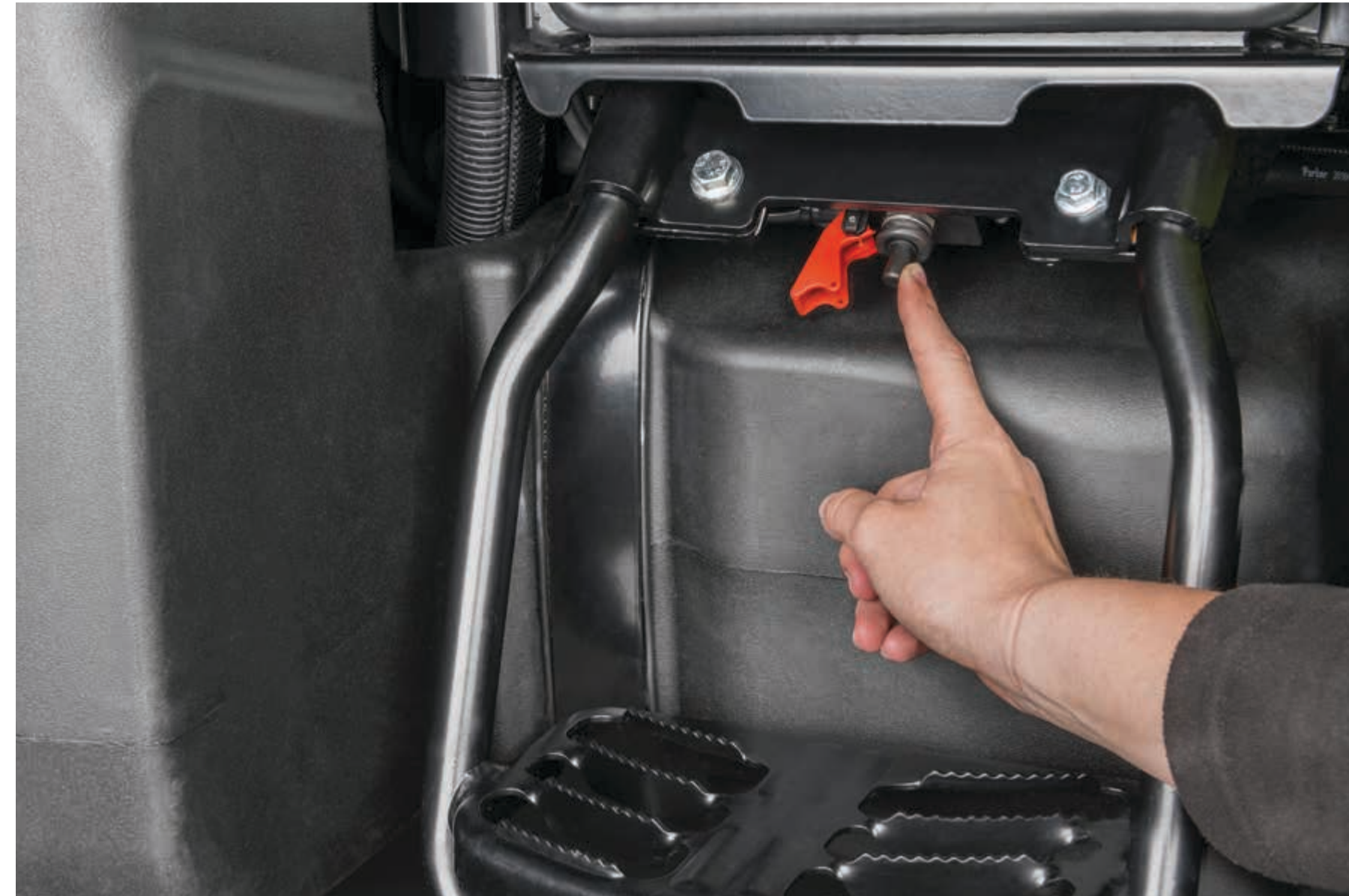
Elektryczny główny wyłącznik akumulatora znajduje się na wysokości lewego stopnia
