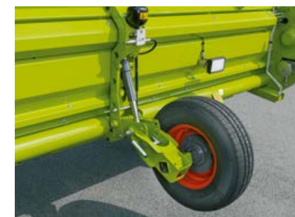
Два прочных стабилизирующих колеса для лучшего ведения по почве
