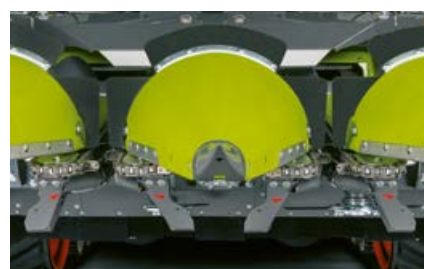
Резиновые уловители початков обеспечивают уборку без потерь.
