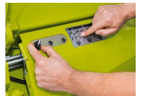
Кнопка для настройки положения парковки и очистки непосредственно на жатке
