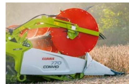
Стебледелители на пружинных опорах для уборки низкорастущих культур.
