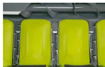
Початкоотделительные пластины регулируются с помощью гидравлики.
