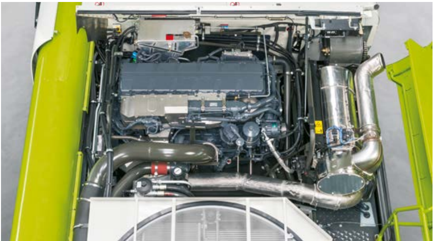
MAN D42 mit 581 kW / 790 PS für LEXION 8900 / 8800.
