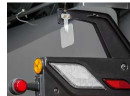
Sensor der automatischen Wurfrichtungsanpassung
