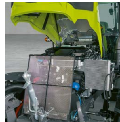
Basta rodar a mão para retirar o radiador e tirar a respetiva grelha para inspeção e limpeza.
