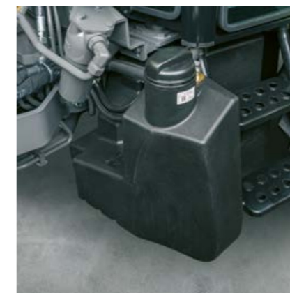
O depósito de diesel de 105 l e o depósito de ureia de 10 l oferecem autonomia suficiente, mesmo em dias de trabalho intensivo.
