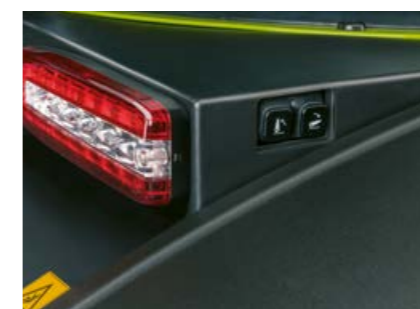
Também pode controlar o elevador traseiro de fora junto a ambos os guarda-lamas.
