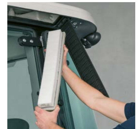
O filtro de ar da cabina é facilmente acessível do exterior para limpeza, facilitando a refrigeração do ambiente na cabina.
