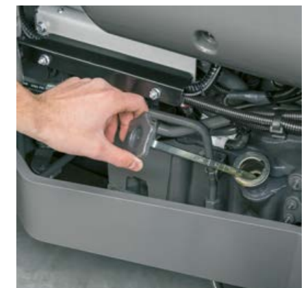
O controlo do nível do óleo e o enchimento são realizados com o capot fechado do lado direito do AXOS 2.
