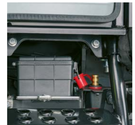
O AXOS 2 simplifica o quotidiano com inúmeras soluções inteligentes, como p. ex. polos da bateria desfasados do lado direito da cabina.
