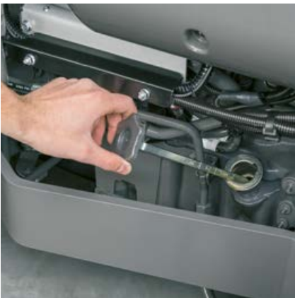
El control del nivel de aceite y el relleno se realizan con el capó cerrado en el lado derecho del AXOS 2.
