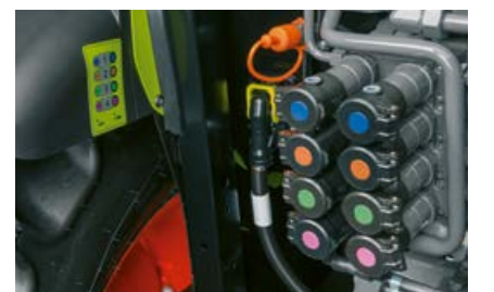
Las conexiones en la parte trasera se reconocen fácilmente por su codificación de colores y los adhesivos colocados al lado.
