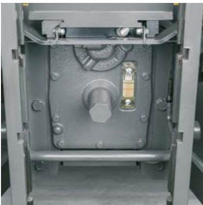
Usted controla el nivel de aceite de los engranajes y la instalación hidráulica con un cristal de observación junto a la boquilla de la toma de fuerza trasera.
