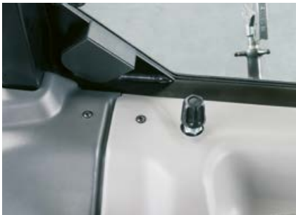
El caudal máximo del tercer mando de control mecánico se puede limitar con una mano desde la cabina.
