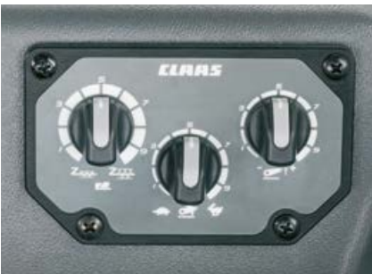
El ajuste de la fuerza de tiro, la velocidad de descenso y la limitación de la elevación los ajusta de forma confortable en la consola derecha.
