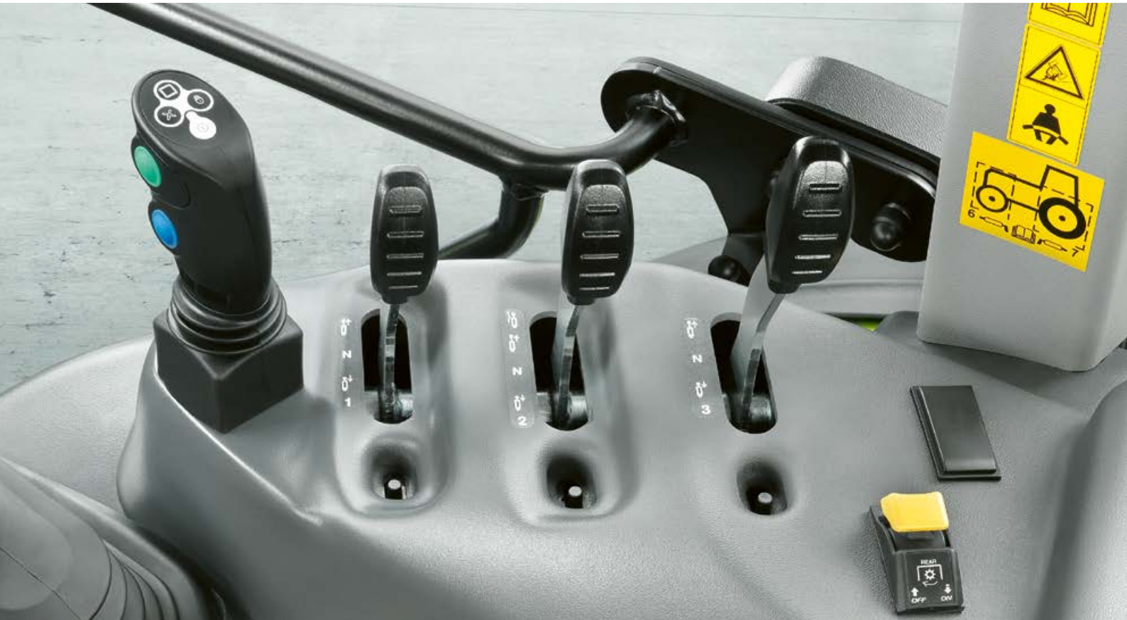
El caudal máximo del tercer mando de control mecánico se puede limitar con una mano desde la cabina.
